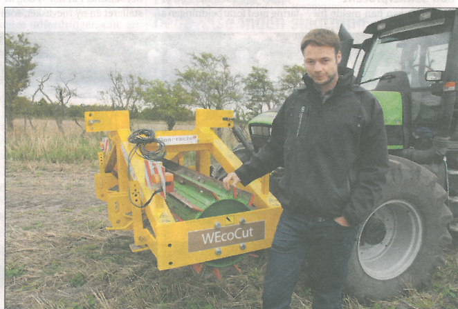
WecoCut-tromlen, der lægger mellemafgrøden ned inden såningen, kan ifølge konsulent ved VFL Økologi, Darran Andrew Thomsen, behandle mellemafgrøden med forskellig intensitet.
